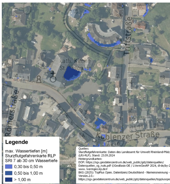
Abb. 26: Max. Wassertiefen der Sturzflutgefahrenkarte des Landes Rheinland-Pfalz (2023, SRI 7) für den Bereich Koblenzer Straße / katholische Kindertagesstätte St. Antonius in Waldesch (Verbandsgemeinde Rhein-Mosel)
